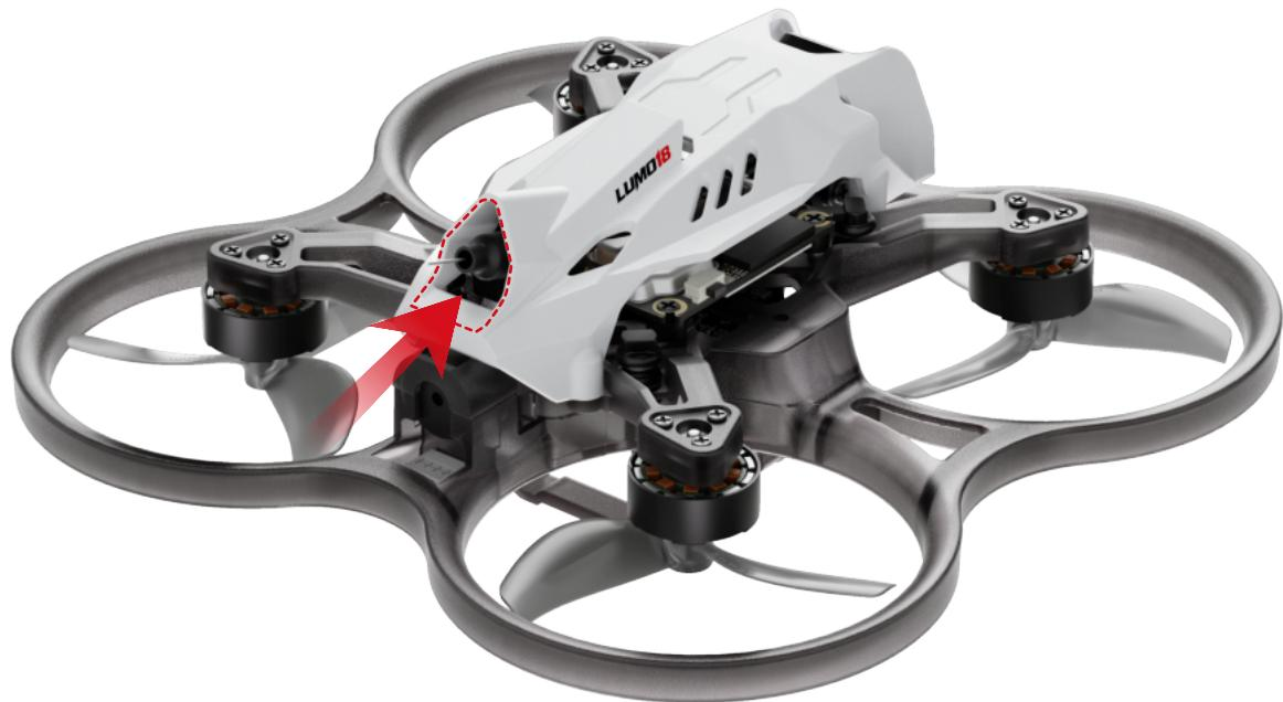
2. 在注塑圈圈底部，使用 4 颗 M1.6×4mm 扁平头十字螺丝固定头罩。
