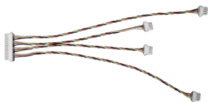
12P 排线 x1 (用于连接Champ竞速LED灯带)
